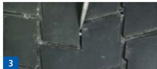
Den Reifen auf Verletzungen untersuchen. Die Profiltrillen des Reifens mit einem geeigneten Werkzeug von Fremdkörpern befreien.
