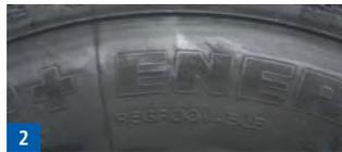
Der Reifen muss auf der Flanke die Bezeichnung „Regroovable“ oder das **U** Symbol tragen. Der Reifen darf keine Verletzungen bis zum Gürtel aufweisen und muss gleichmäßig abgefahren sein: kein starker einseitiger Abrieb, kein Bremsplatten, keine größeren Auswaschungen. Die Restprofiltiefe beträgt idealerweise zwischen 2 und 4 mm.
