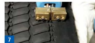
Zunächst werden die Längsrillen (Hauptprofilrillen mit Verschleißindikator) des Reifens geschnitten. Anschließend (je nach Bedarf gemäß der Nachschneideempfehlung) wird das Profil quergeschnitten. Die Temperaturstufe am Nachschneidewerkzeug ist so zu wählen, dass der Gummi beim Nachschneiden nicht „verbrennt“.
