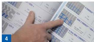
Aus der Nachschneideempfehlung (ab S. 85 in dieser Broschüre) das entsprechende Profil auswählen. Dort wird erläutert, welche Rillen wie tief nachgeschnitten werden dürfen und welches Messer zu verwenden ist.
