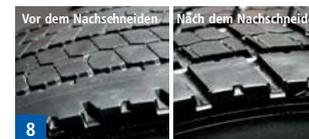
Man kann deutlich erkennen, dass durch das Nachschneiden mehr Profil für eine zusätzliche Nutzungsdauer und damit ein Plus an Laufleistung entstanden ist. Zusätzlich sorgen die neuen Drainagerillen und Traktionskanten für eine Erhöhung der Haftung bzw. Traktion des Reifens.
