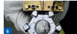
Aus der Nachschneideempfehlung das entsprechende Messer auswählen und in Breite und zuvor ermittelter Tiefe einstellen. Als zusätzliche Hilfe zur einfacheren Einstellung der Nachschneidetiefe dient der sogenannte Gabarit (Schablone mit Einstellwerten von 4 bis 9 mm).
